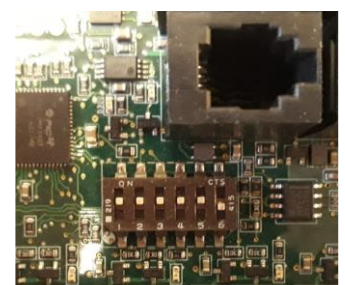
Рис 6 Положение DIP-переключателя для использования обогревателя
