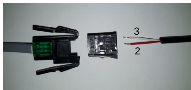
Anschluss des Temperatursensorkabels Kabel mit Anschlüssen 2 und 3 verbinden.
